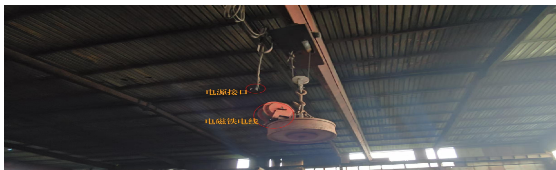
起重机加挂电磁吸盘照片
