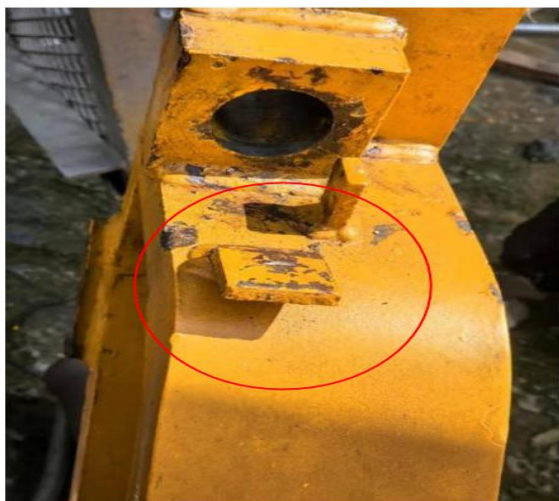
图 13 限位板断裂失效图
