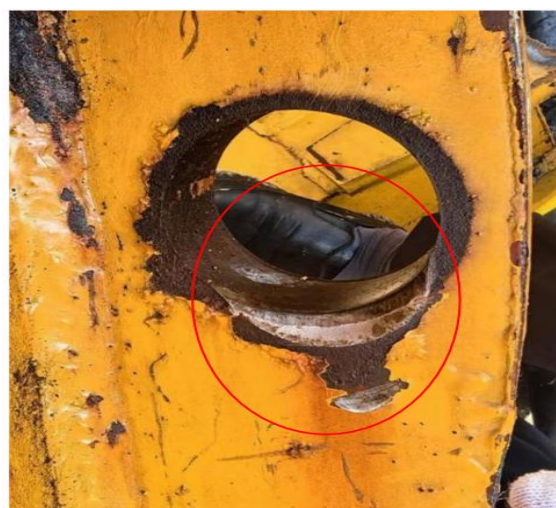
图 12 踏步中孔内侧挤压变形图
