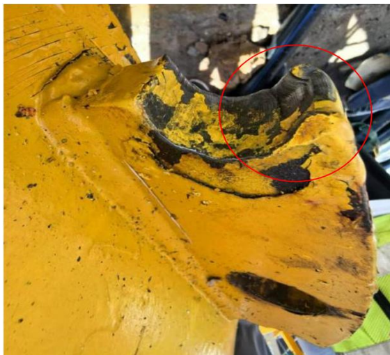
图 15 踏步弧形槽受冲击变形放大图
