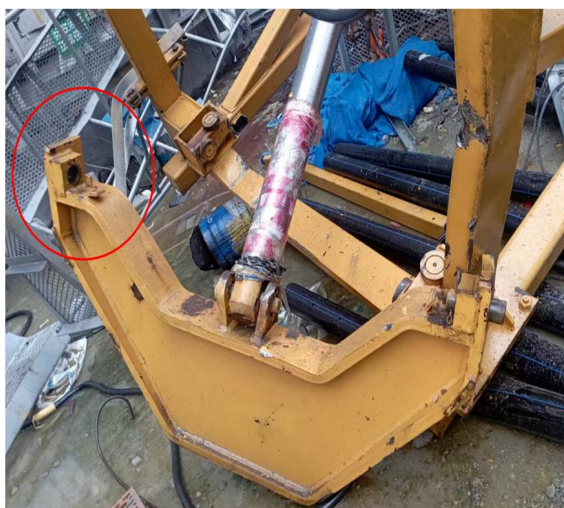
图 11 事故后顶升横梁图
