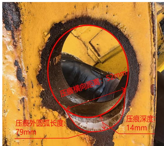
图 14 踏步中孔变形局部放大图
