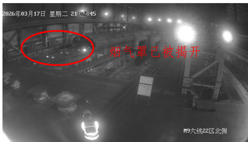
图 3 M9-L606 石墨化炉出现异常情况后被揭开烟气罩的情况
