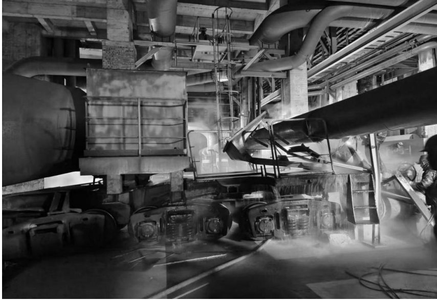
图三 机车从高 15 道冲出后调车棚与管道发生碰撞
