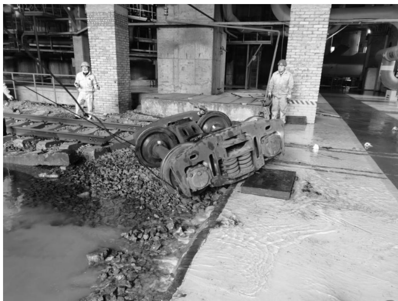
图二 脱轨的第一轮对（由北向南拍）
