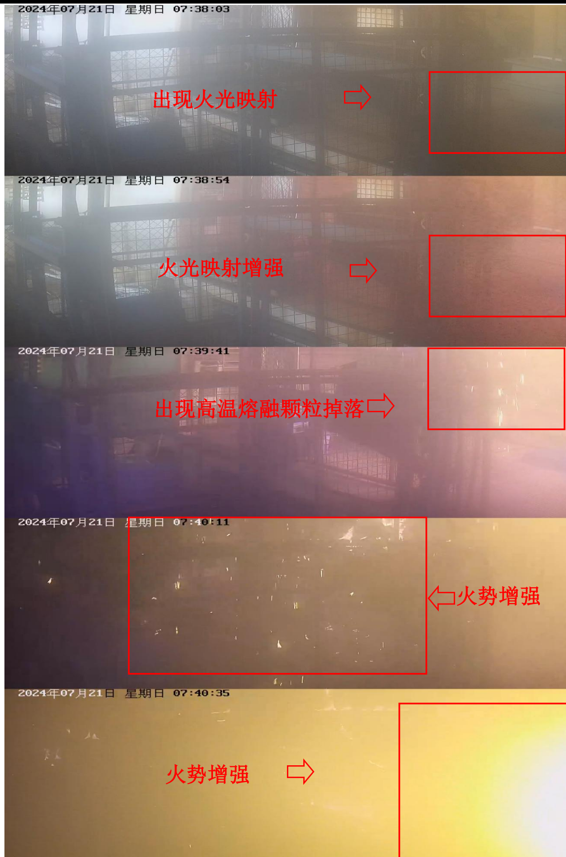
图 8 检材 SX240413-S03 火势发展过程
