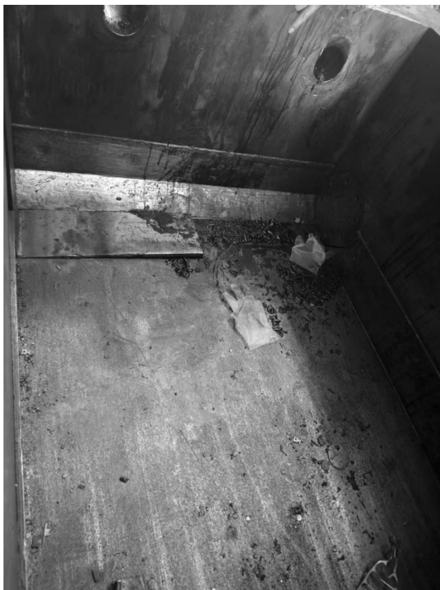
图 5 打包机内留有加热痕迹突起的矩形翻板
