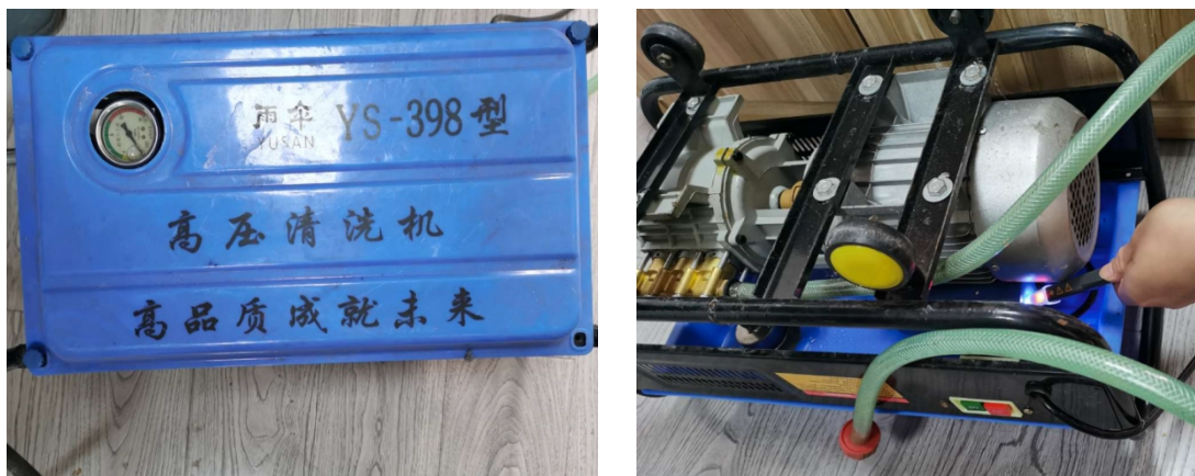
图 2 高压清洗机漏电检测现场图
