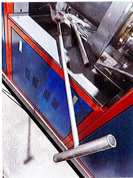
图三：料筒和模具清理工具
