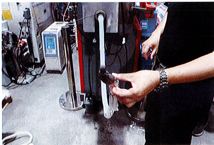
图二：射出的胶条，灰色部位为加入银粉的导电胶
