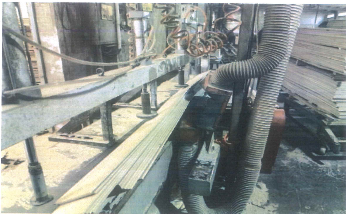
图四：修直机器发生事故后状态
