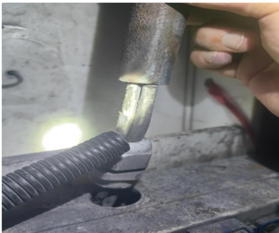
图 7：从间隙处将套管往上推，可见电线破损
