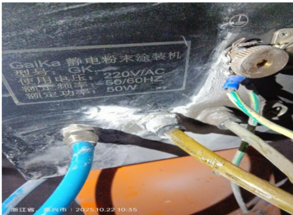
图 10: 静电粉末涂装机使用电压 220V/AC, 额定频率 50/60HZ
