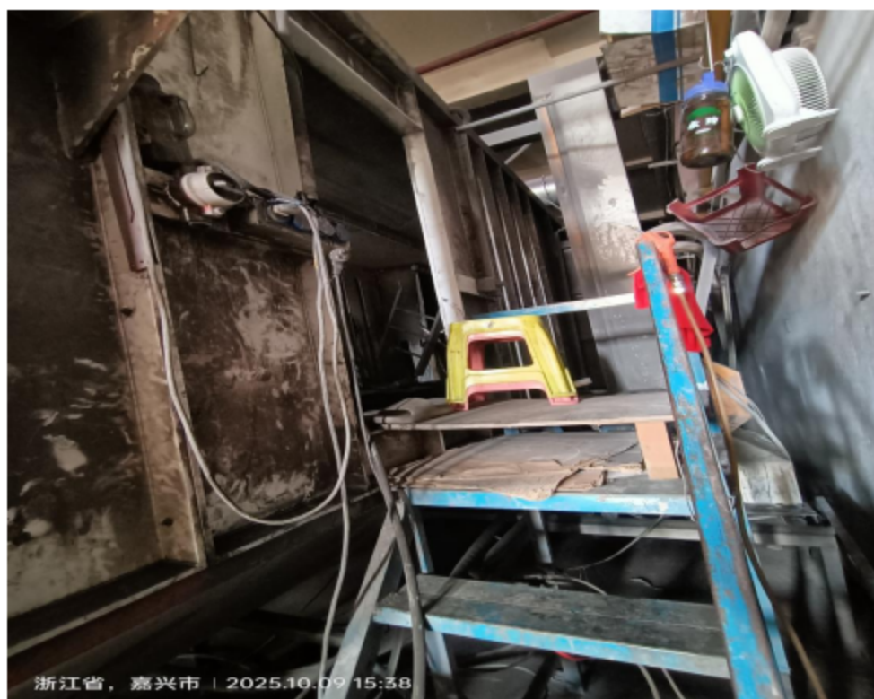
图 3：涉事工位放置硬板纸、木板、塑料凳
