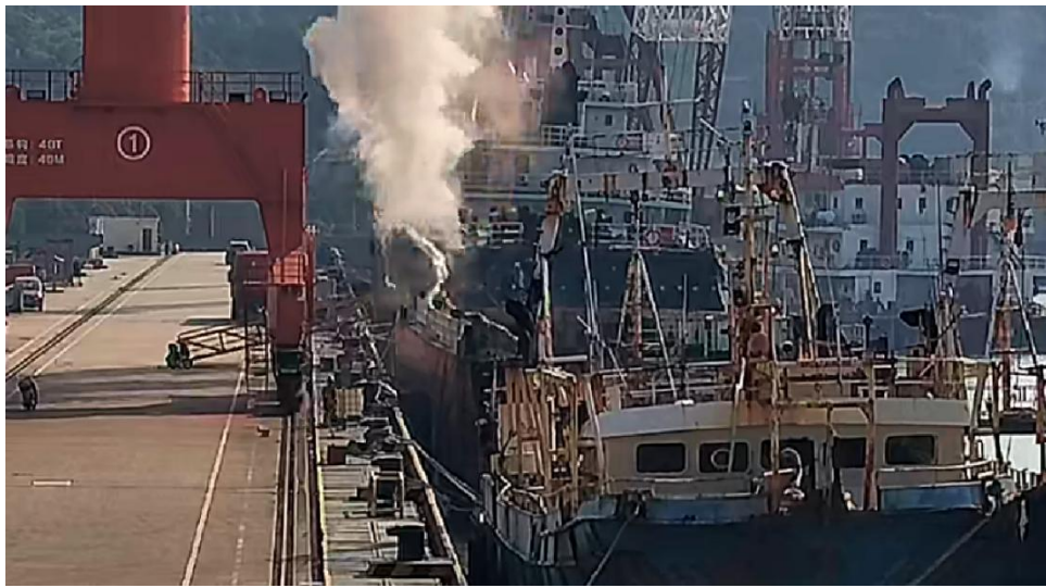
14:22:21 (3380 帧), 左舷 1 号压载舱爆燃后冲击波触底反射并携带油污水从道门喷出。
