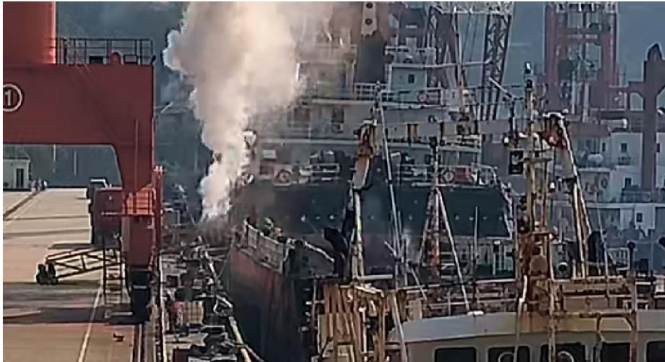
14:22:24 (3442 帧), 左舷 1 号压载舱 L 型底舱焊缝受冲击波影响破裂导致油污水和烟气喷出。
