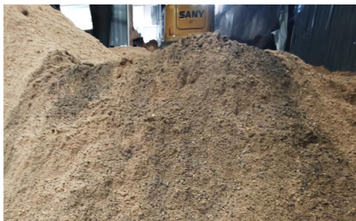
图 2-2 成品冷却仓中部位置木质生物质颗粒有大量碳化痕迹现场图
