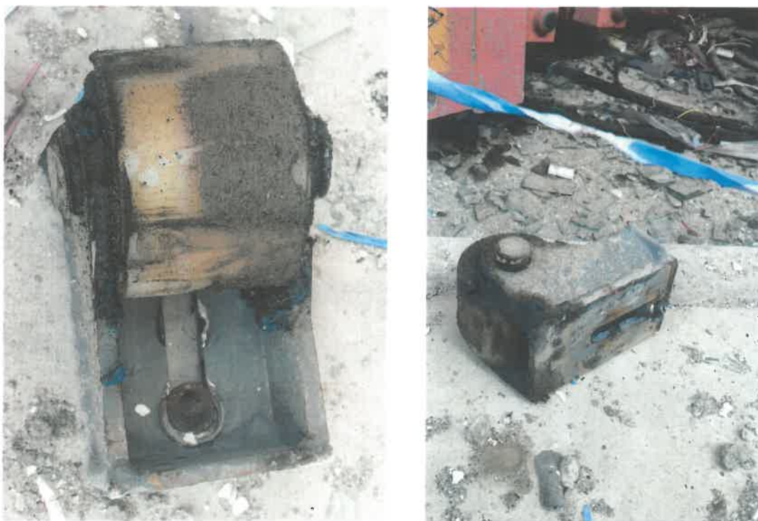
图 4-6 地面散落的平衡轮组件
