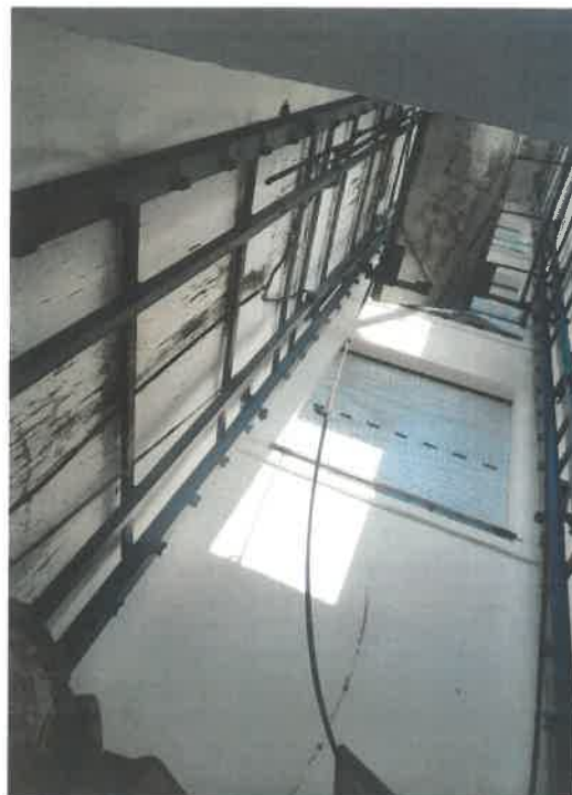
图 4-8 挂在平台上链条链节脱开的链条
