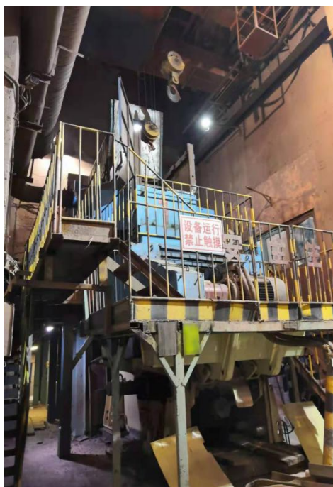
图 1 1 号颚式破碎机
