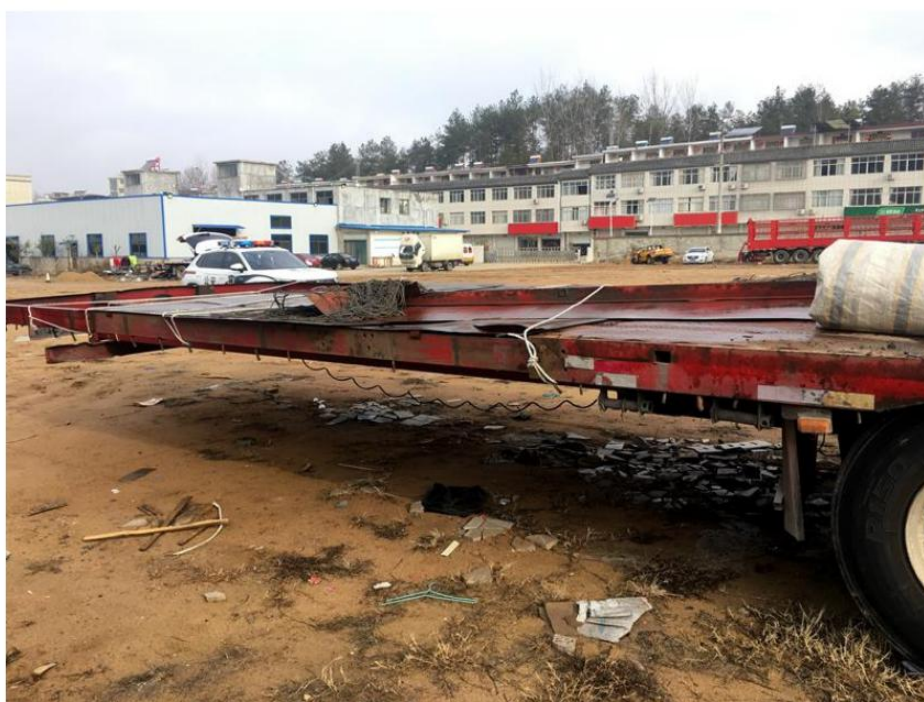
图 3 平板车尾部加装的钢板
