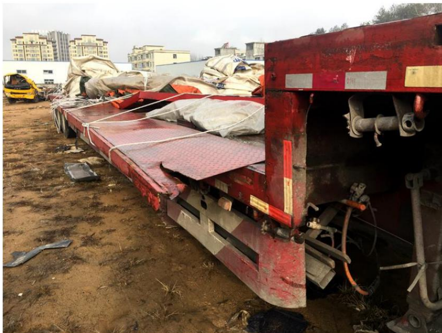
图 2 平板车加装的超宽钢板
