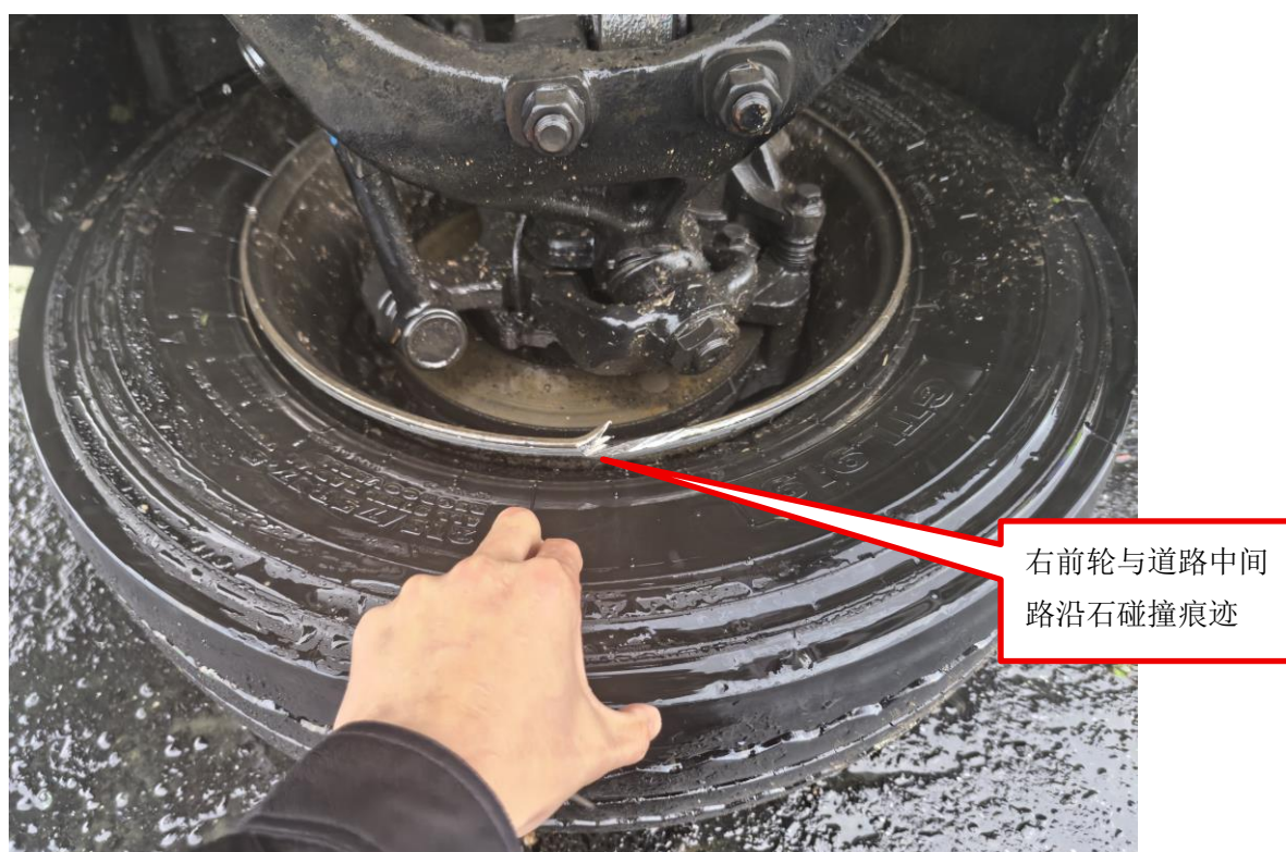
(图 7: 车辆右侧轮胎碰撞部位)
