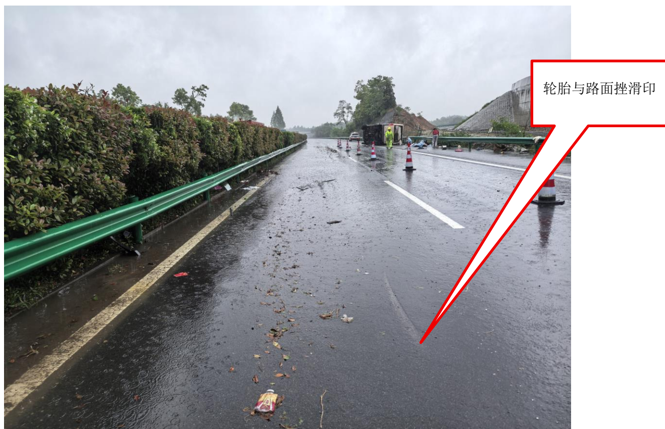
（图 8：车辆碰撞中央护栏后的轮胎挫滑印）
