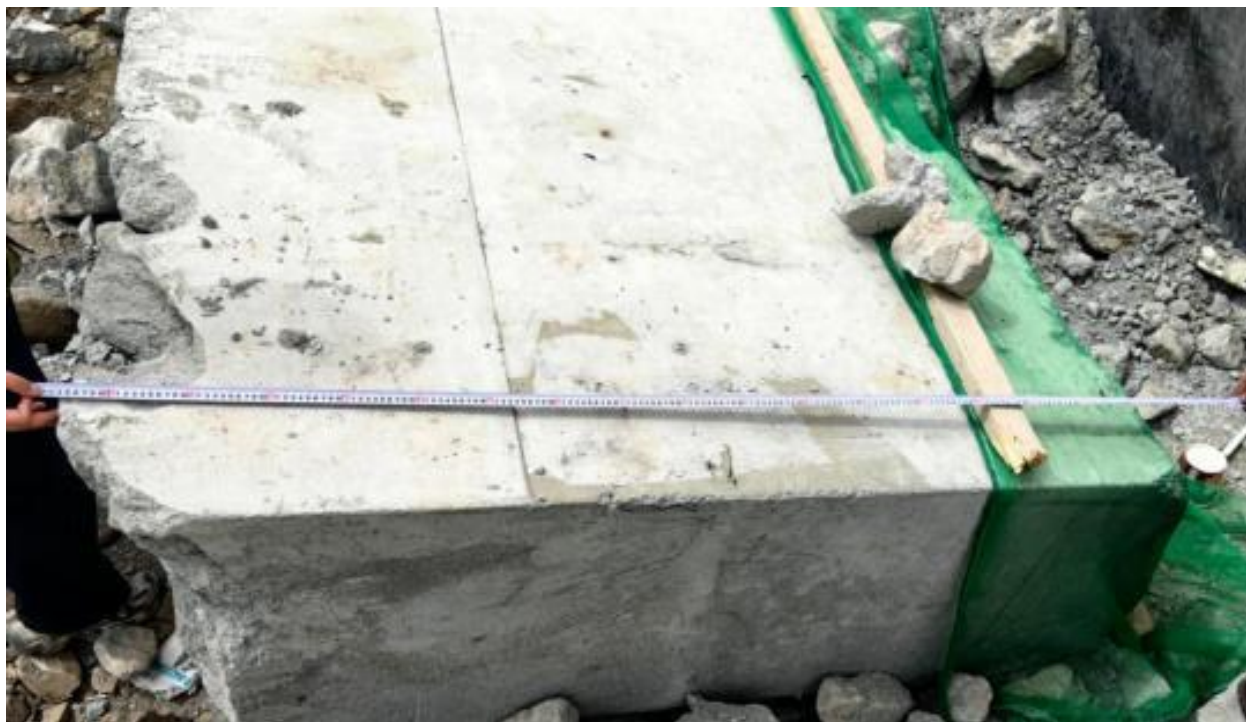
图 2 碎裂后墙体残余墙身
