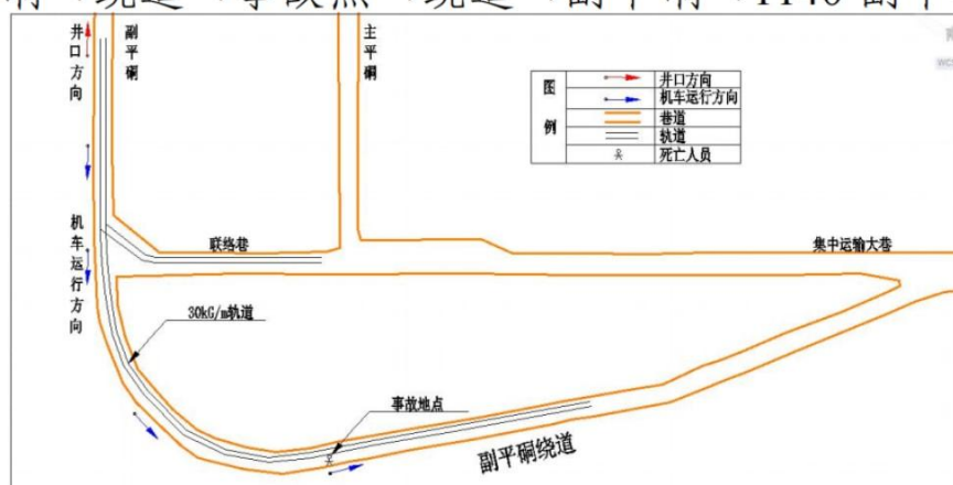
图 1 大竹园矿“7·4”事故现场平面图
