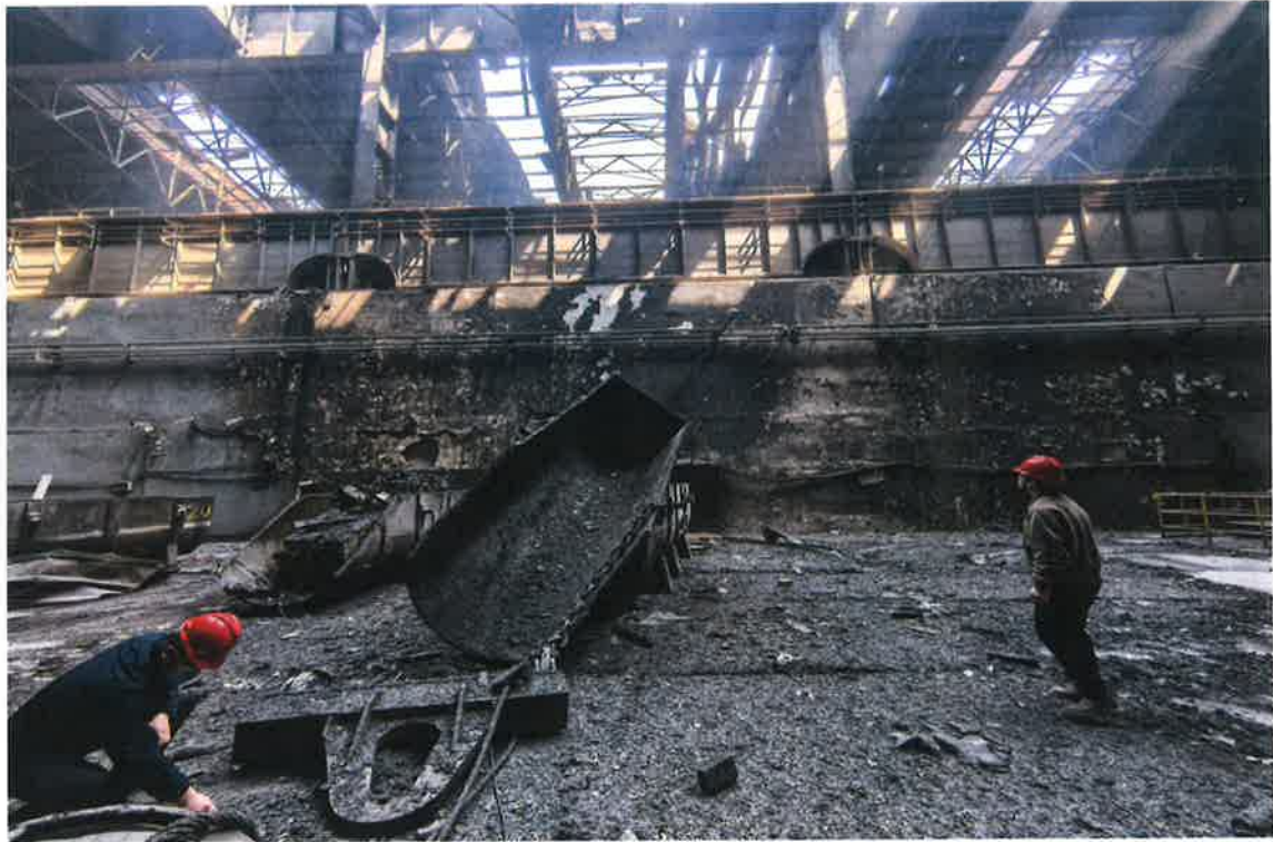
图 2 转炉正前方--钢水爆喷范围
