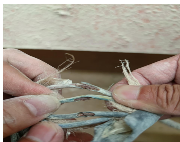
图 2 绝缘层破损的导线
