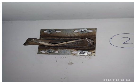
图 7：肇事的手拉葫芦上吊钩挂点
