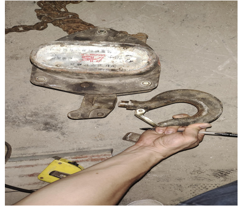
图 2：断裂的上吊钩转轴
