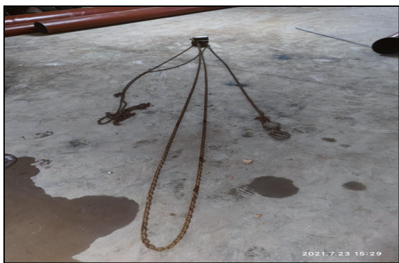
图 8：手拉葫芦铁链
