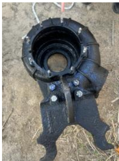
图4 3#潜水排污泵蜗壳和耦合器支架图
