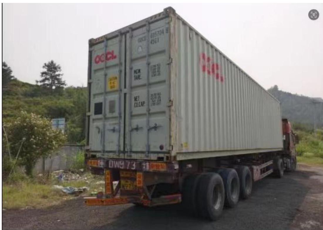
图 4 牵引闽 DW973 挂号重型集装箱半挂车
