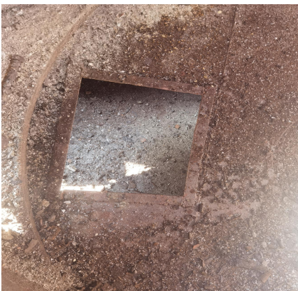
图10：烘干炉上的观察窗
