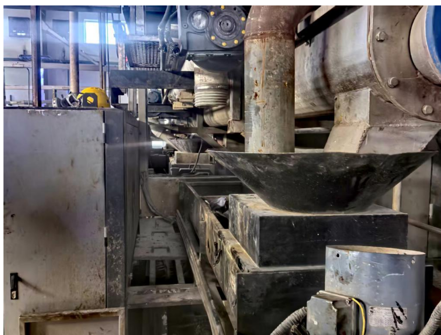
图二 污泥改性混合机
