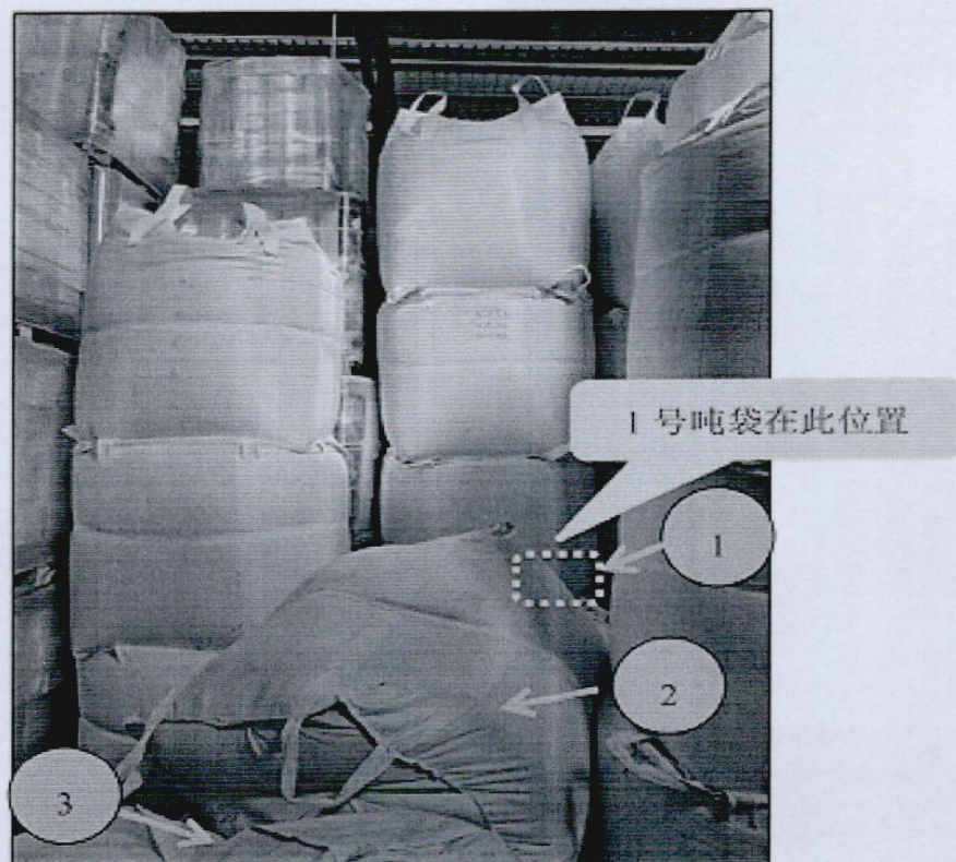
图3 倒塌的吨袋（序号表示层数）
