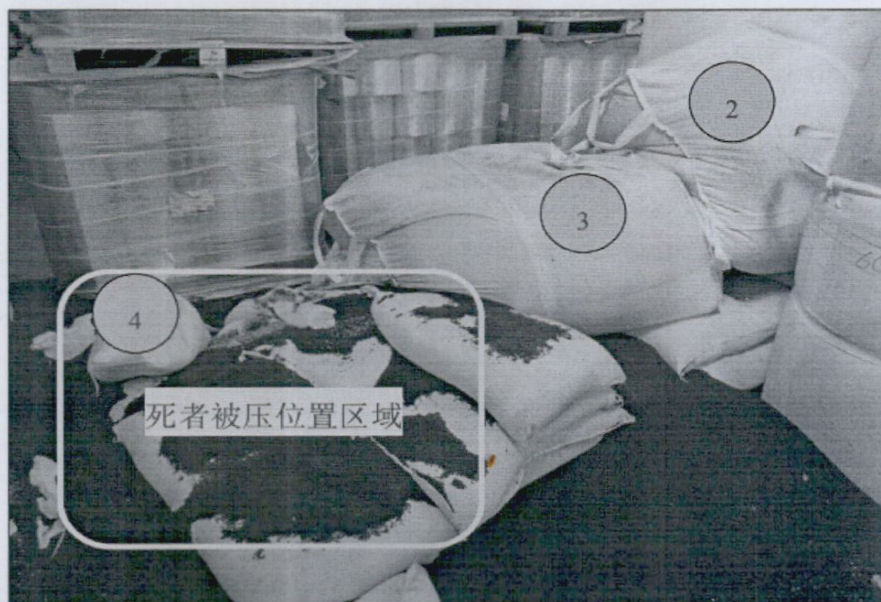
图 2 倒塌的吨袋情况（序号表示层数）
