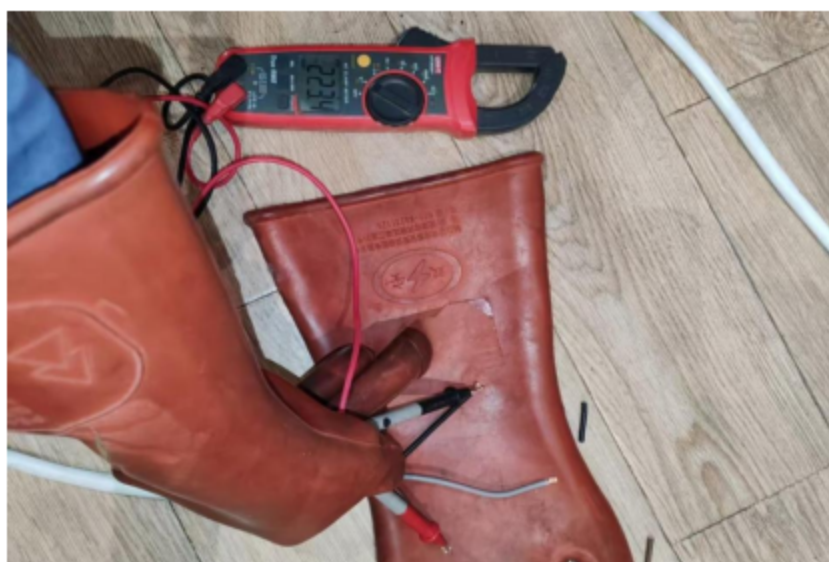
图 6 合上大堂 LCD（1）开关后测量裸露火线对地线的电压
