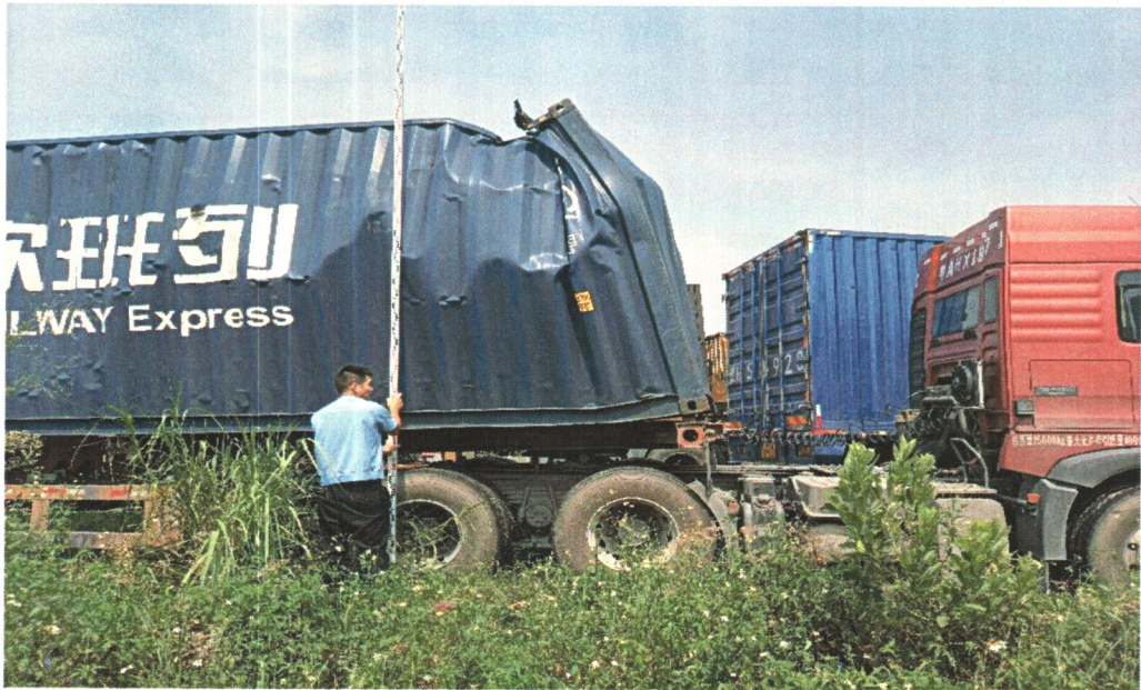
图 3: 粤 AHX187 号重型半挂牵引车货厢右前侧碰撞变形照片
