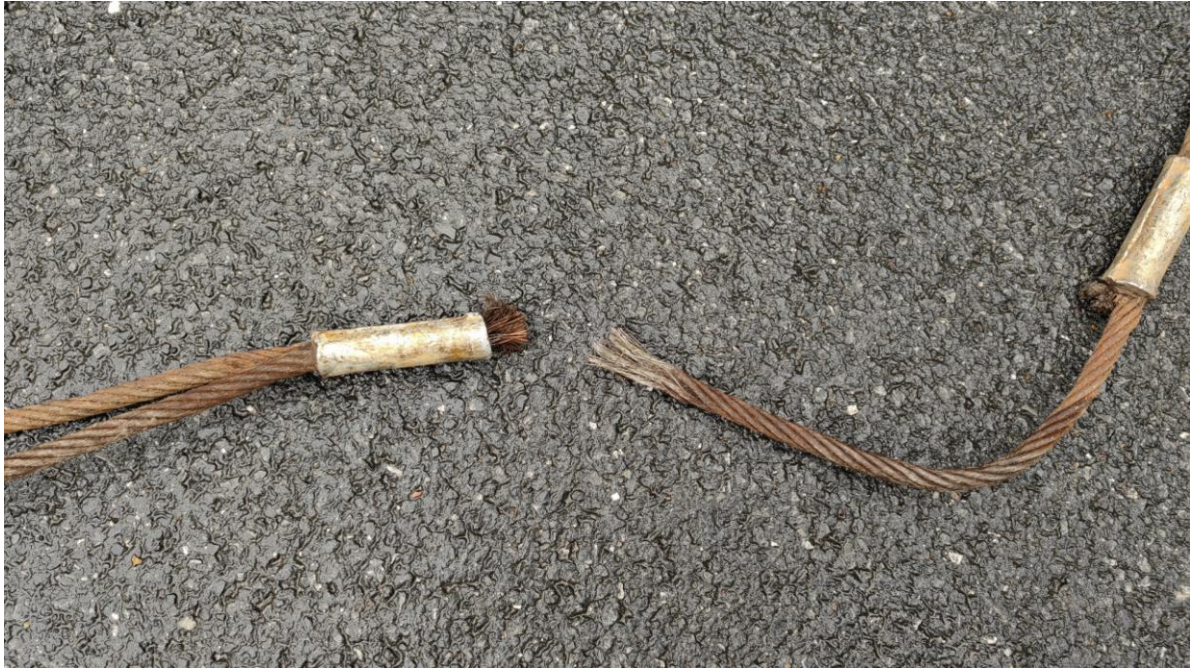
图 12 完全断裂的钢丝绳（公称直径 12mm）
