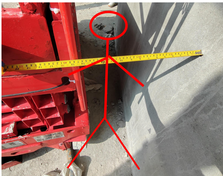
图 9 红色剪叉式升降工作平台左后方防护栏与水泥墙距离约为 370mm。 李某被夹在此处。
