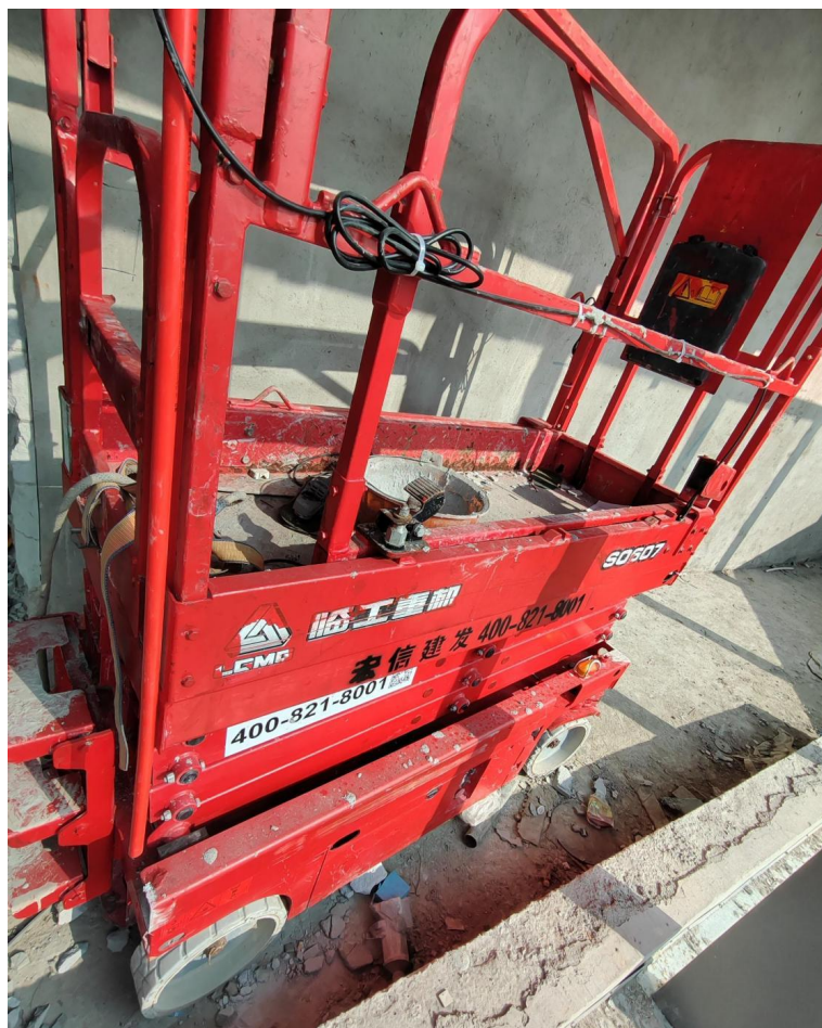
图 4 3 层后勤通道现场停放的剪叉式升降工作平台侧面标注设备型号为 S0607，剪叉式升降工作平台四周有防护栏。
