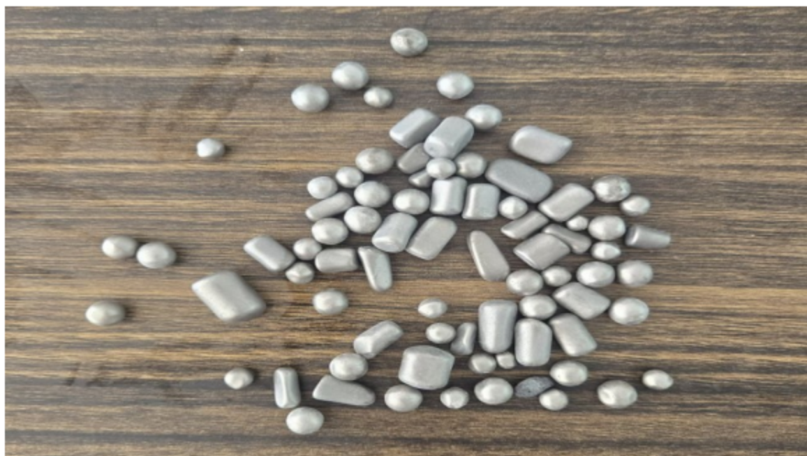
图 2 管磨机内研磨体图
