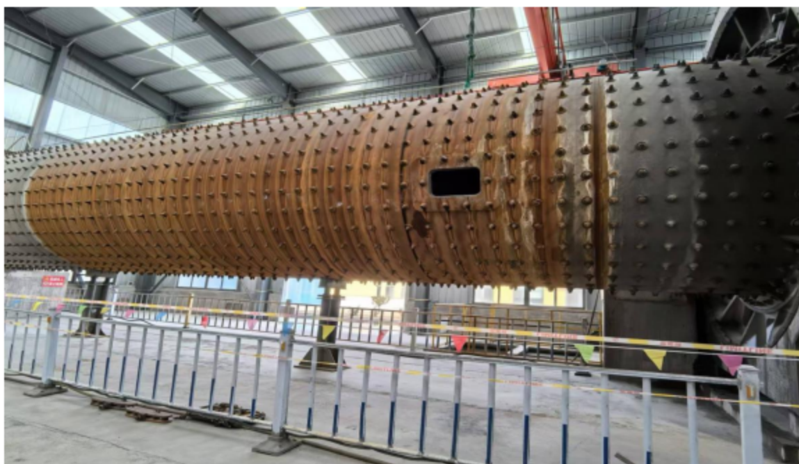
图 3 管磨机研磨二仓图
