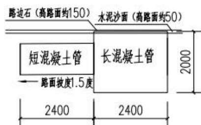
混凝土管停放平面图 1:100
