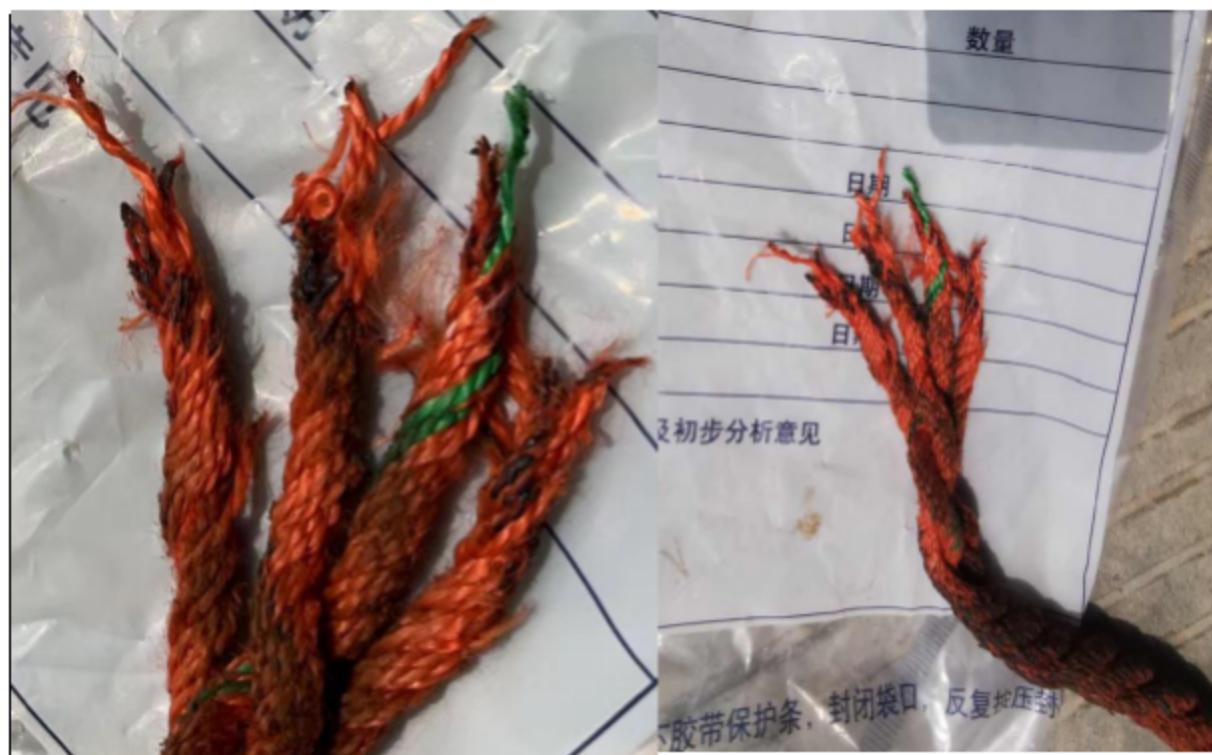
图三 安全带断裂处
