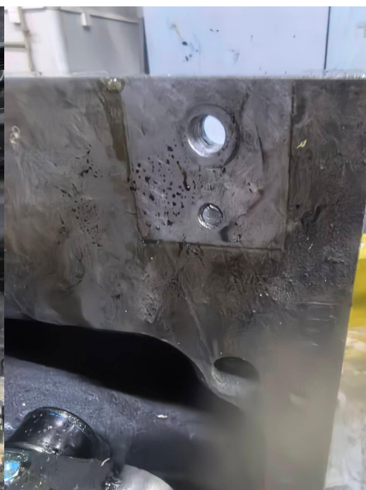
图 4 设备本体右侧螺纹孔内遗留有一颗断口螺栓残骸图
