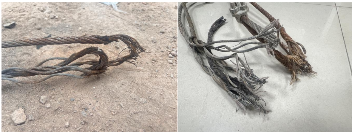
图6 涉事钢丝绳套断点情况
