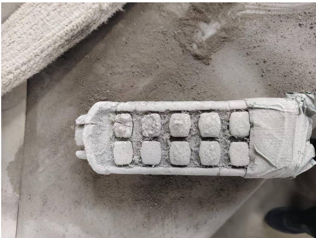
图 3 事故起重机械无线遥控装置
