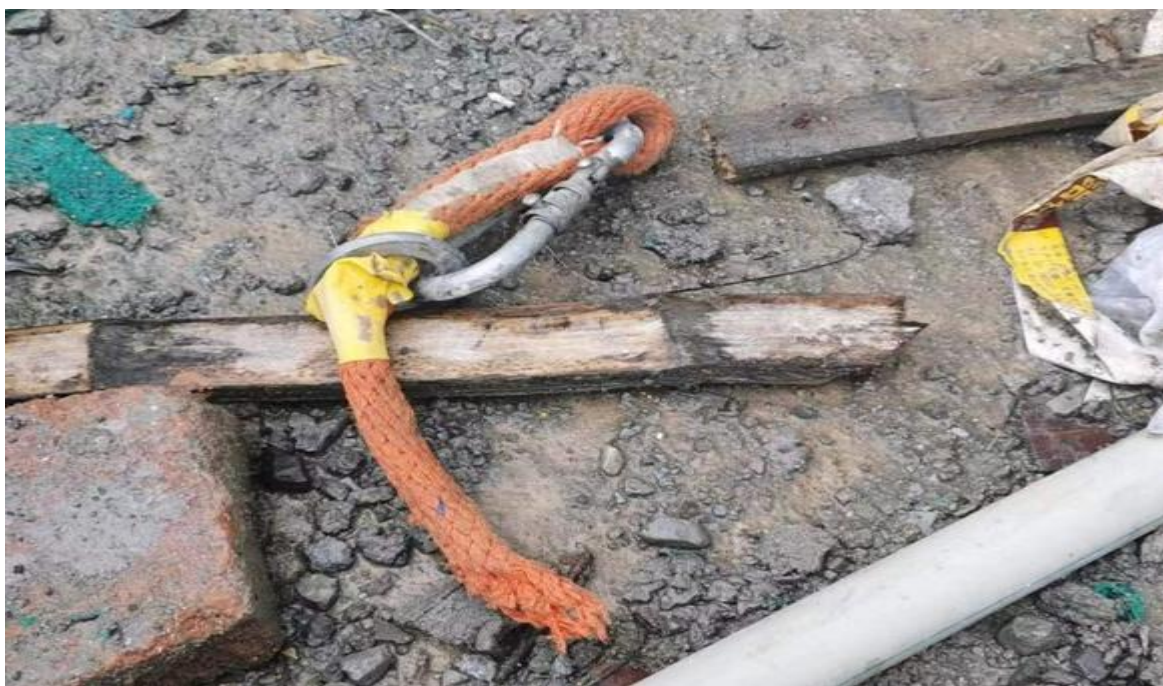
图四、何**所佩戴的安全带断裂部分
