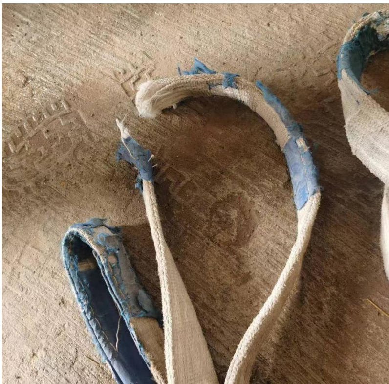
图 4-1 吊装带断裂位置
