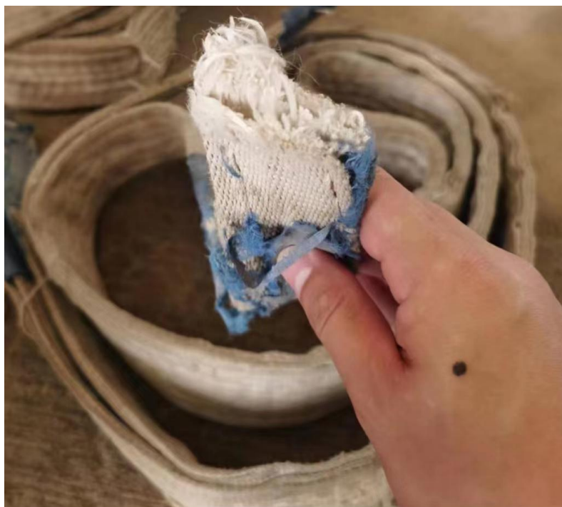
图 4-1 吊装带断裂位置
