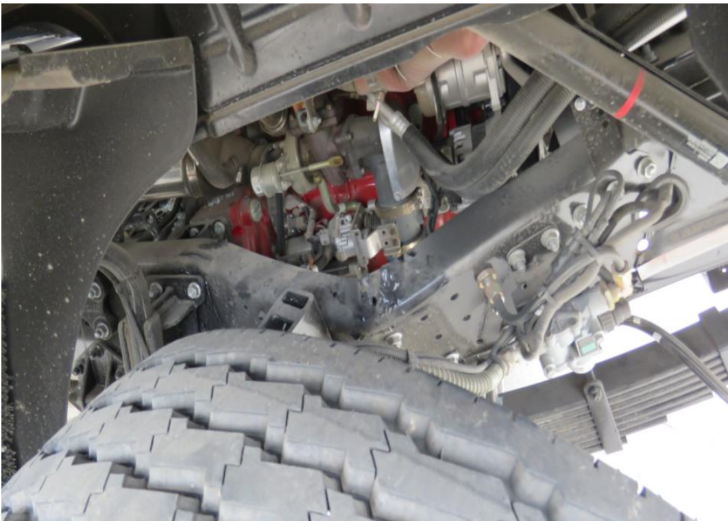
图 3 车架大梁前端发生向上弯折变形
