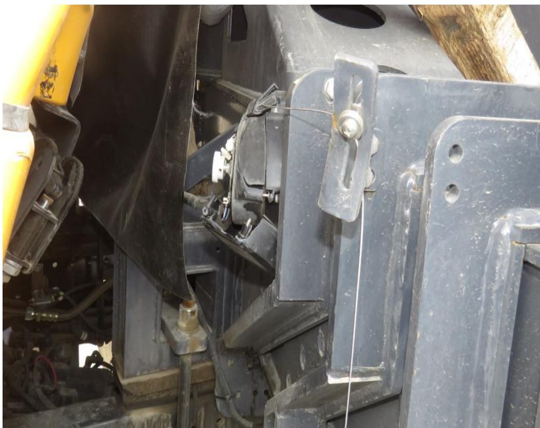
图 4 左前支腿长度传感器受挤压损坏
