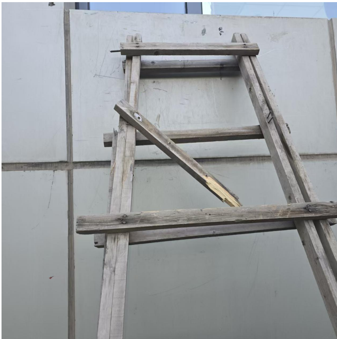
图 2 事故木梯第二踏板断裂
