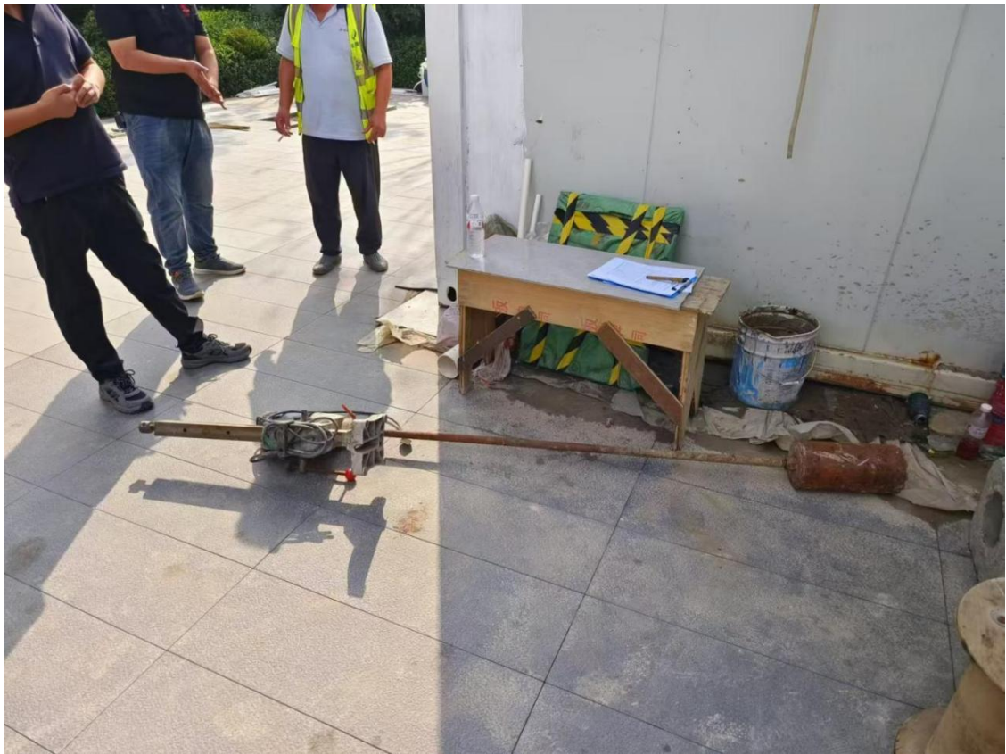
图二 现场勘验时连接金属管和钻头后的水钻机
