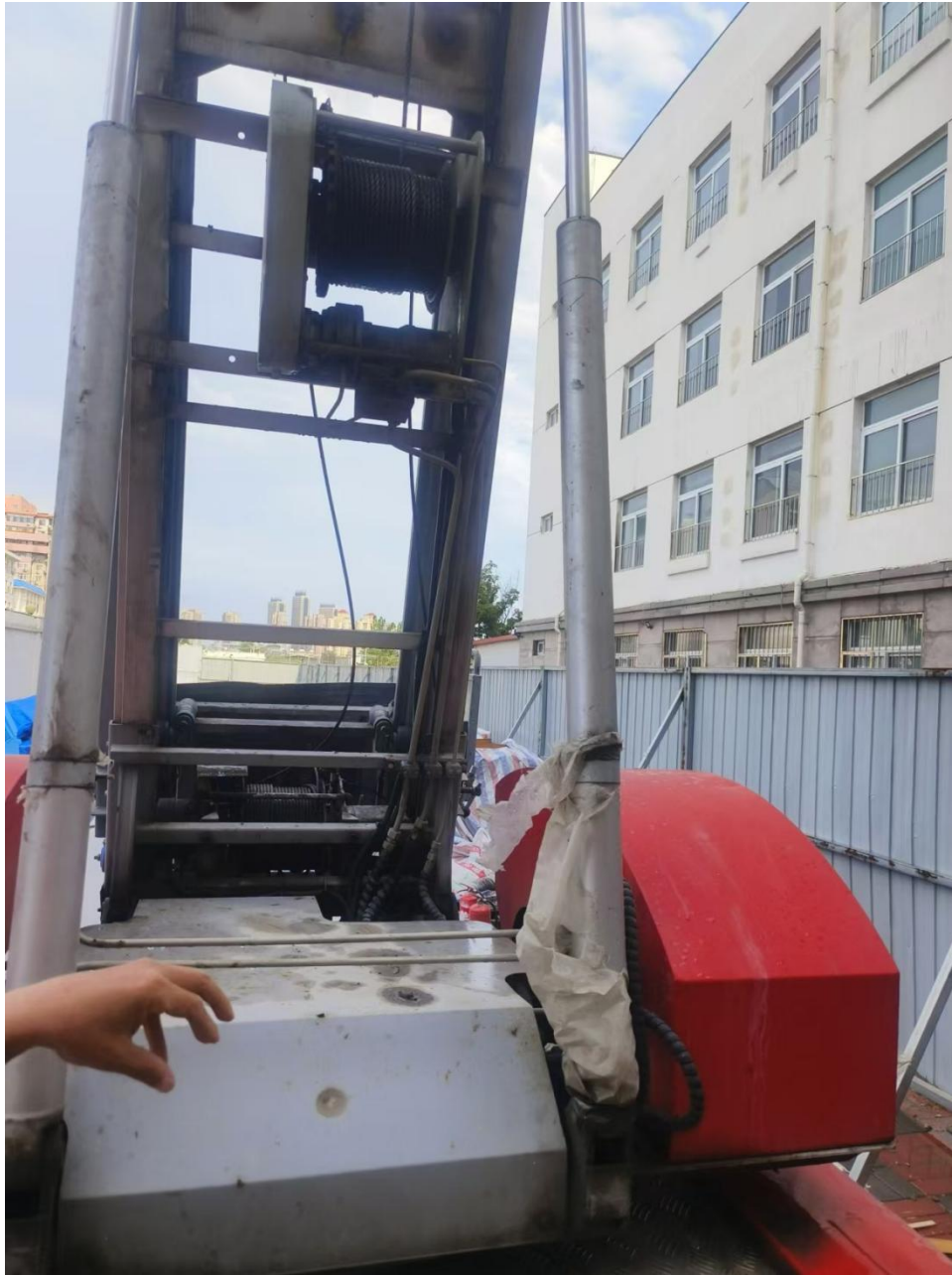
图五 事故发生后钢丝绳处于松弛状态
