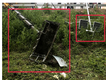
图 2 作业平台及路灯杆倾倒情况
