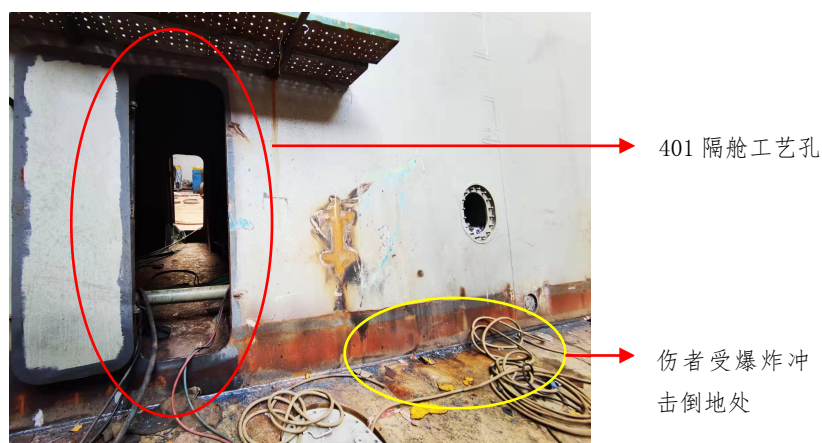
图 5 401 隔舱工艺孔及伤者受爆炸冲击倒地处
