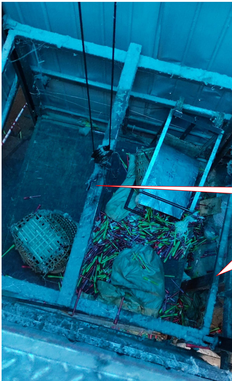
图 3 自制升降设备货厢框架顶部痕迹
