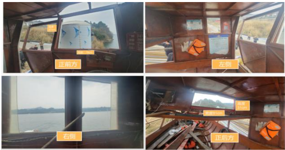
图 14 模拟事发前驾驶位左侧盲区
