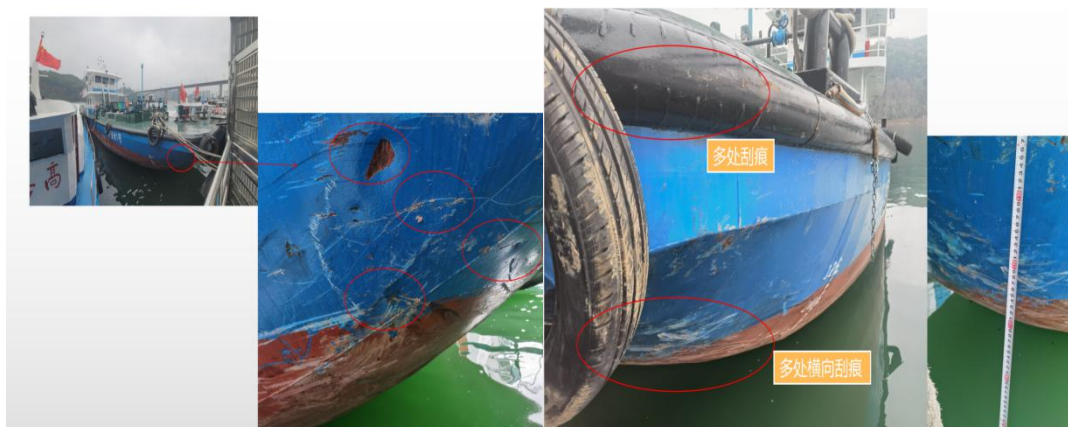
图 15 船首右前下方外板油漆刮擦、局部凹陷
