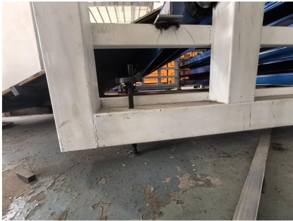
图3 板材架“顶升器”
