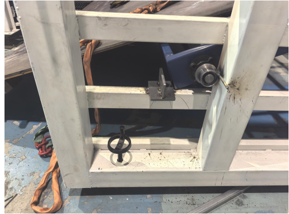
图 6 东南角滑轮焊接情况
