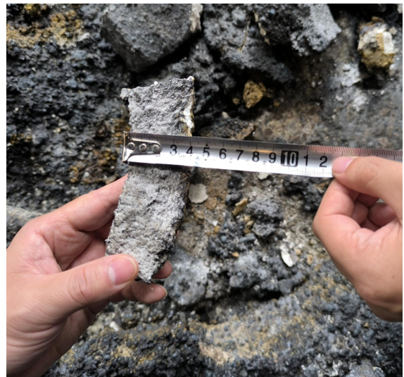
图 2：中频炉内耐火层厚度为 40mm
