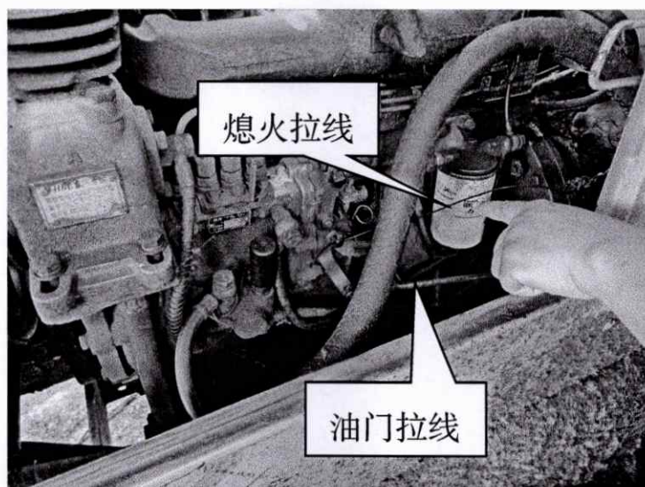
(发动机处的熄火拉线、油门拉线)
