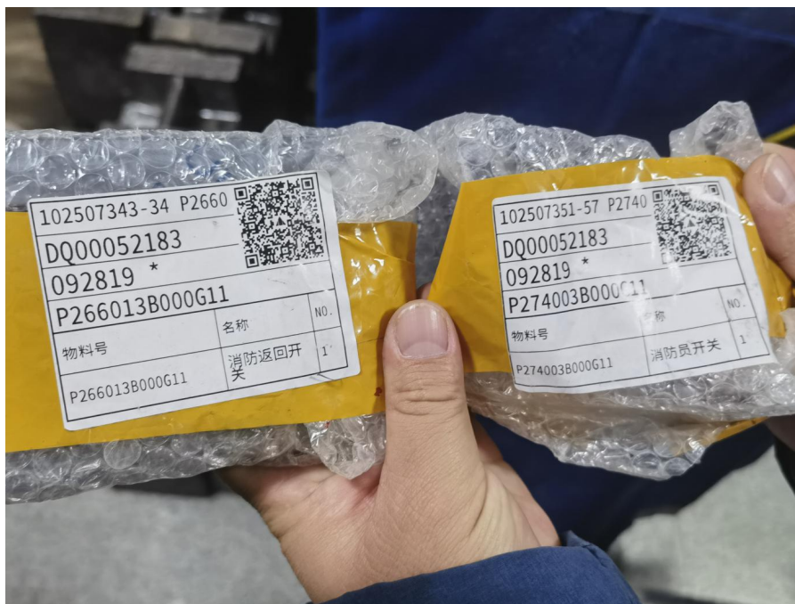
图 2 现场遗留的未安装的消防返回开关和消防员开关部件
